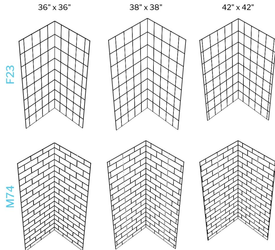
Les motifs de carreaux illustrés sont une représentation de ce qui sera réalisé pour chaque modèle et taille lorsque les manuels d'installation Fleurco sont suivis. Les panneaux doivent être coupés pour s'adapter à chaque espace. Le schéma de motif peut être repensé en ajoutant des panneaux supplémentaires. Contactez le service à la clientèle pour plus d'informations.
